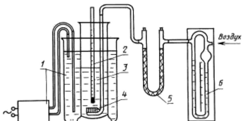
1 — водяная баня с термостатом; 2 — термометр; 3 — мерный цилиндр; 4 — газопромыватель; 5 — трубка с хлористым кальцием; 6 — реометр
