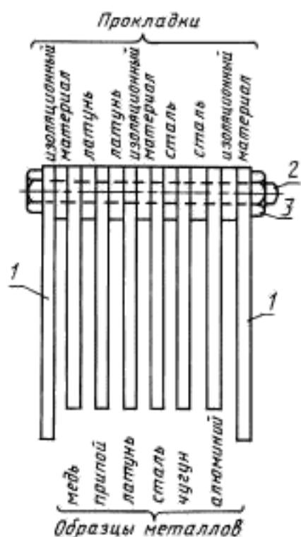
1 — латунные подставки; 2 — крепежный винт; 3 — гайка
