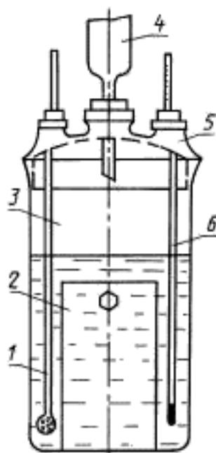
1 — аэратор; 2 — держатель образцов металлов; 3 — сосуд; 4 — обратный холодильник;
